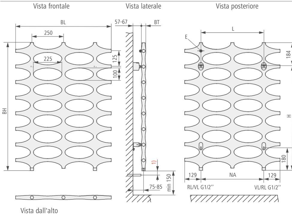
Distanza dal bordo inferiore del radiatore al pavimento min. 150 mm.
